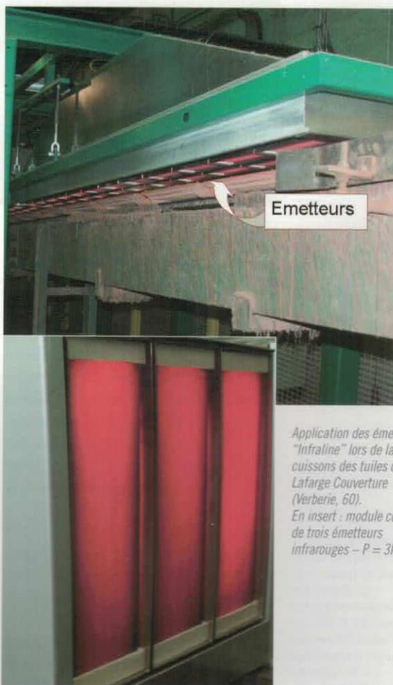
*Application des émetteurs "Infraline" lors de la cuisson des tuiles chez Lafarge Couverture (Verberie, 60). En insert : module constitué de trois émetteurs infrarouges - P = 3kW.*
